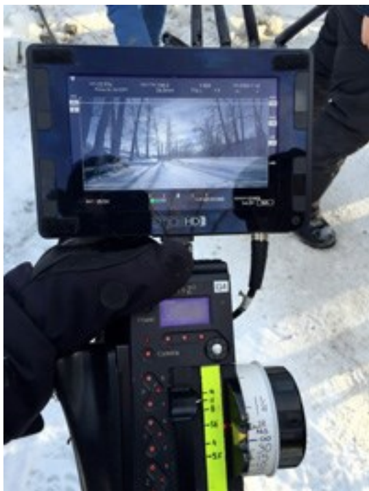
Obrázek 8. – 7“ monitor SmallHD, dálkové ostření ARRI WCU a Terradek Bolt, prvního asistenta kamery Michaela Merrimana ve filmu Revenant
