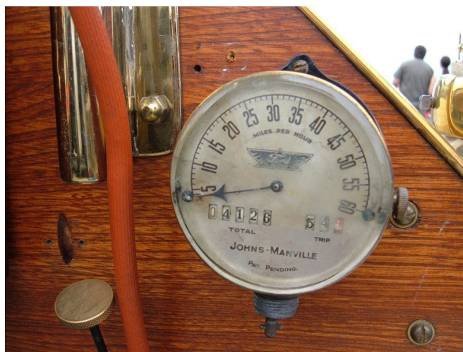
Obr. 1. Rychloměr vozu Ford Model T Speedster z roku 1913
