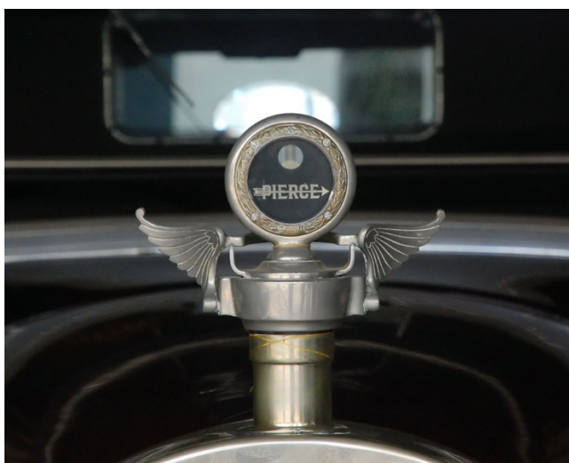
Obr. 9. Teploměr na voze Pierce-Arrow, 1919
