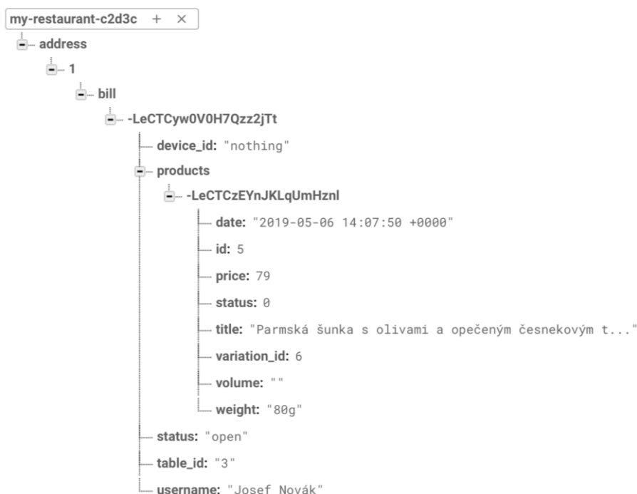
Obrázek 29 - Struktura databáze Firebase
