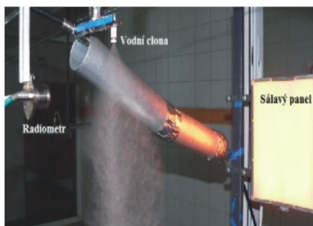
Laboratorní sestava pro měření poklesu tepelného záření přes vodní mlhu
