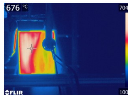
Obrazový záznam z termokamery ukazuje nakoľik skutočne dokáže vodní mlha odclonit tepelné záření.
