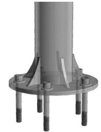
Obr.45: Vizualizácia kotvenia stĺpu 60–80 mm
