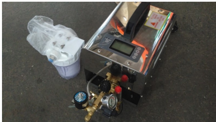
Obr.64: Čerpadlová jednotka BASIC TIME 300 W 60 bar, 1 l/min, 8-12 trysiek od firmy PKS servis spol. s.r.o. v Ostrave
