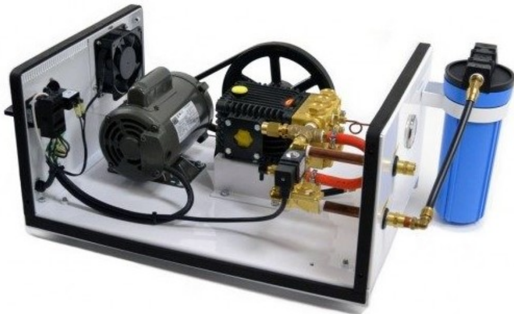
Obr.51: Čerpadlová jednotka Pulley Drive Mist Pump, 70 bar, 12 l/min (90-150 trysiek) v protihlukovej skrini, chlazením a filtráciou z www.fogco.com
