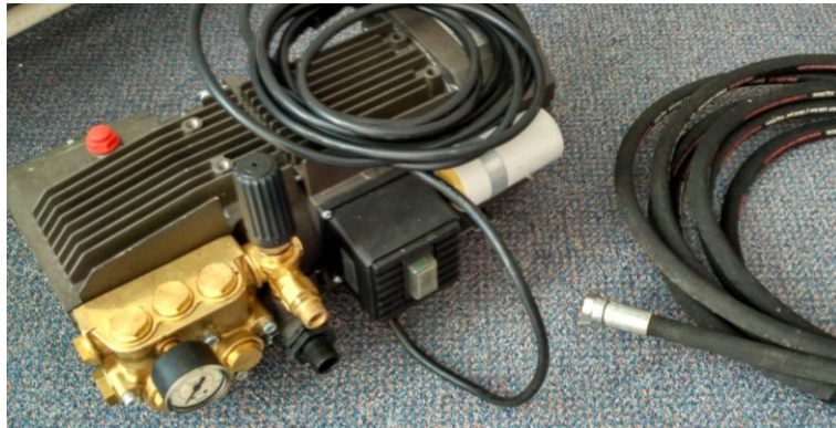
Obr.65: Čerpadlo ANNOVI REVERBERI HPE-M 02.08, 1000 W, 0-90 bar, 0-2 l/min na 20-25 trysiek od firmy AKP spol. s.r.o. v Brne
