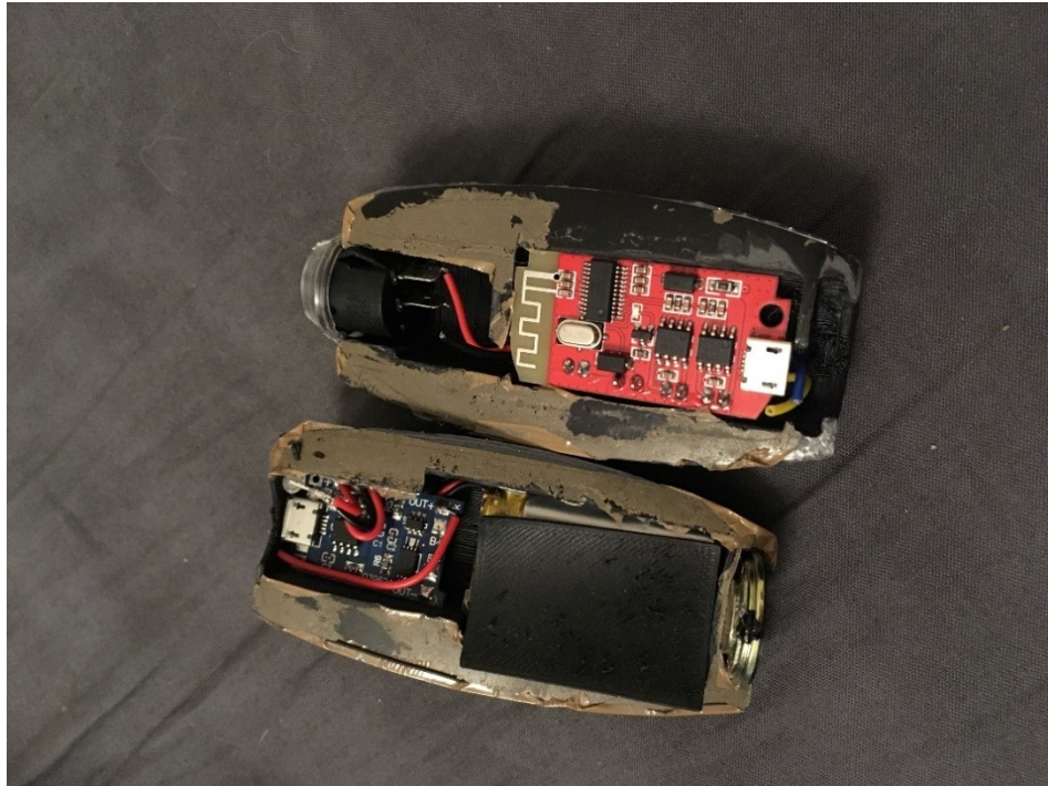
Obr. 44. Uložení elektroniky v pouzdře
