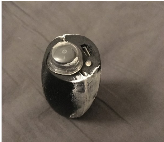
Obr. 45. Spojení pouzdro s elektronikou
