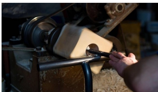
Obr. 12 Ukázka výroby dřevěné formy soustružením
