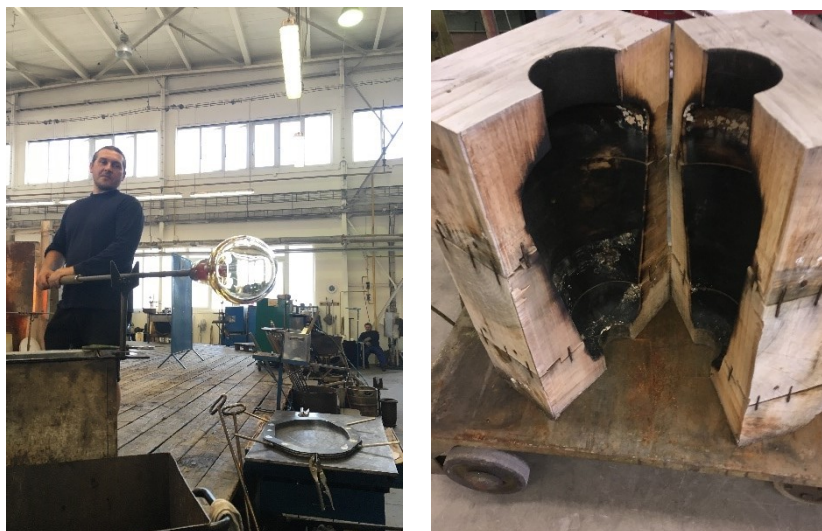
Obr. 28 Ukázka z výroby technikou ručního foukání do dřevěné formy
