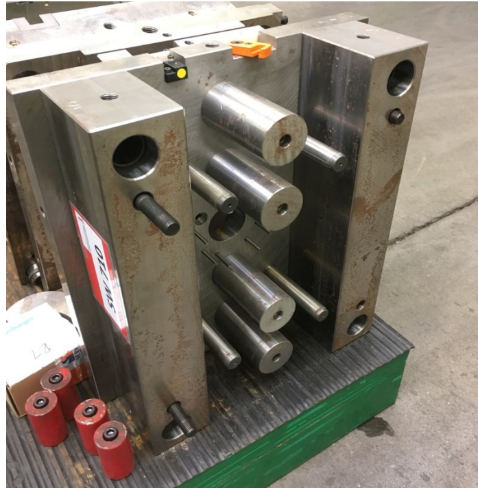
Obr. 73 Část pohyblivé strany formy
