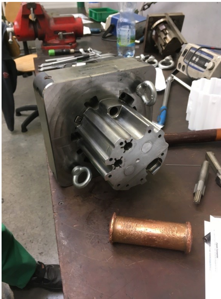
Obr. 56 Tvarová vložka pohyblivé strany
