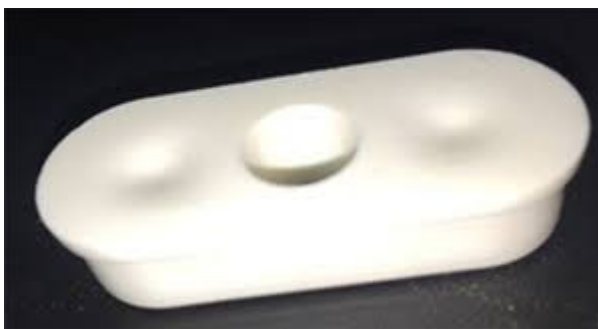
Obr. 47 Propady na vstřikovaném díle
