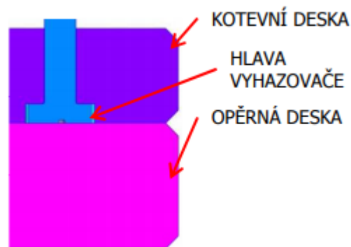
Obr. 14 Schéma uložení vyhazovače mezi vyhazovacími deskami [9]
