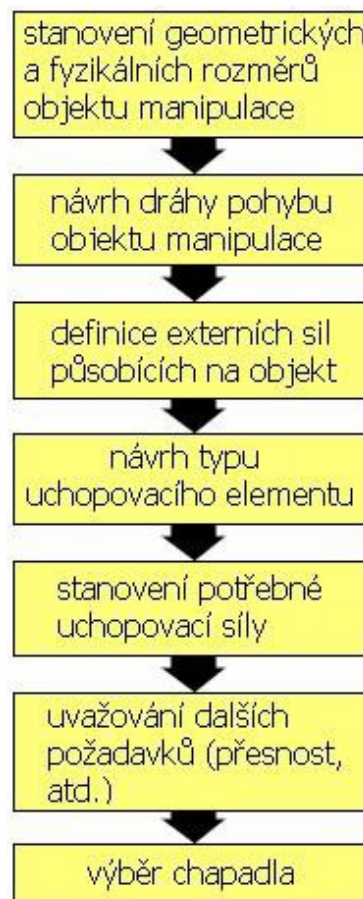
Obr. 16 Posloupnost návrhu koncového efektoru [16]
