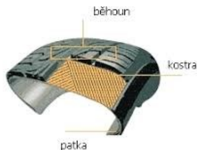
Obr. 4 - Diagonální konstrukce pláště [18]
