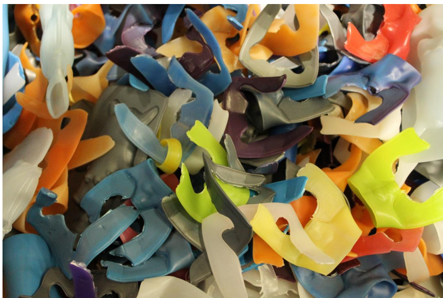
Obr. 6 Technologický odpad – PE [8]
