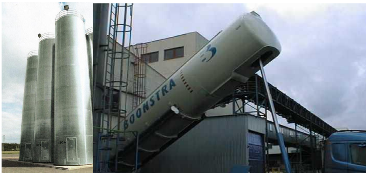
Obr. 8 Sila pro granulát a ukázka plnění z cisterny [8]
