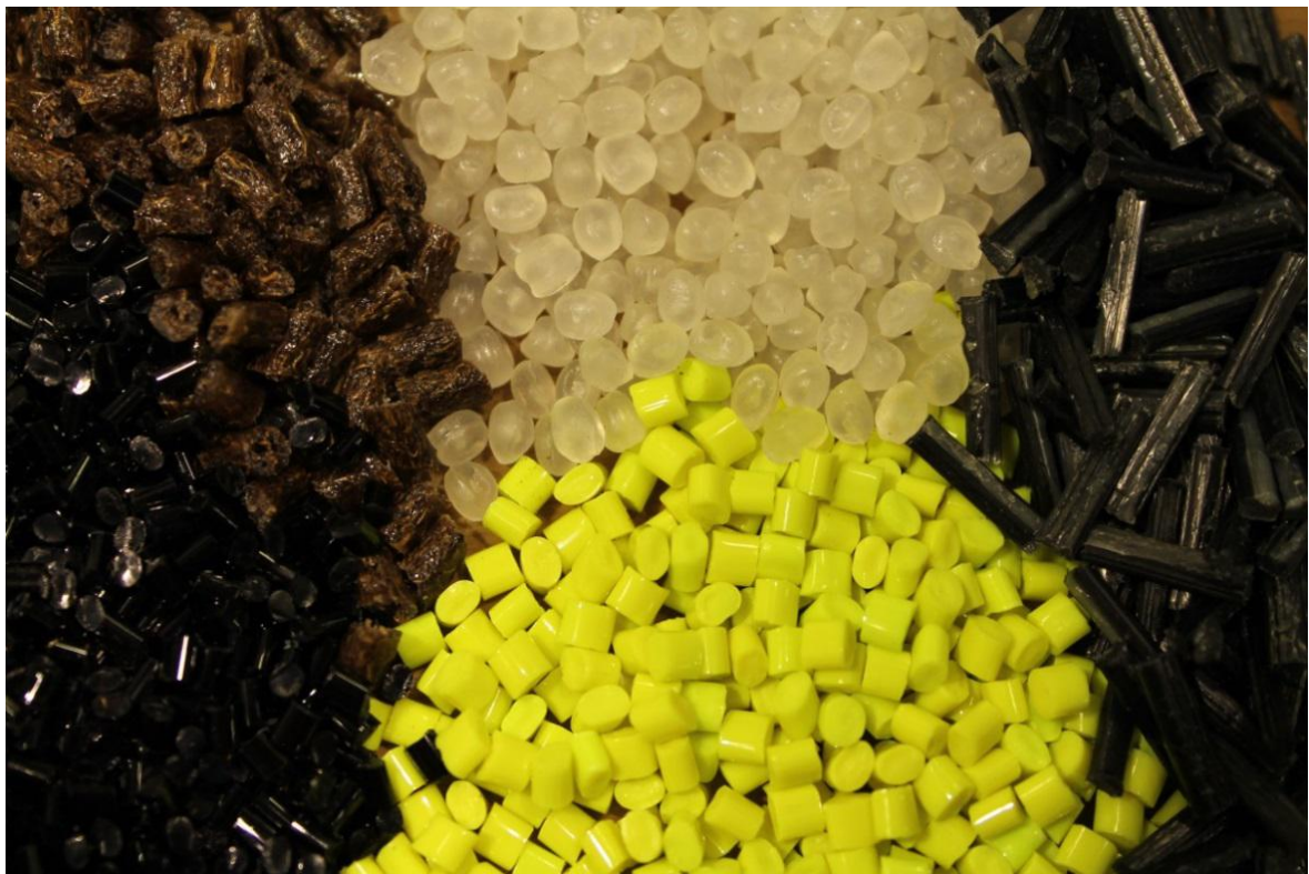
Obr. 5 Příklady tvaru granulí termoplastů [8]
