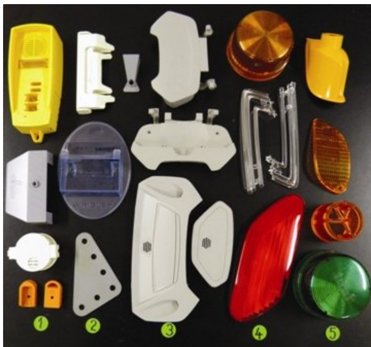
Obr. 2 Výstřiky z amorfních termoplastů [5]
