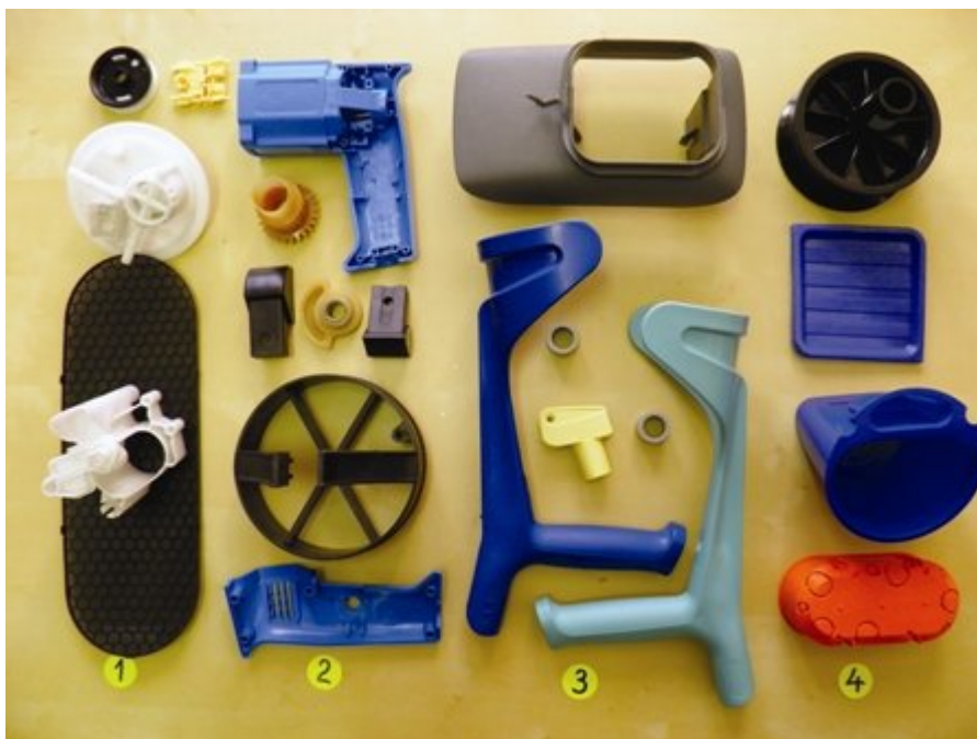
Obr. 3 Výrobky ze semikrystalických termoplastů [5]
