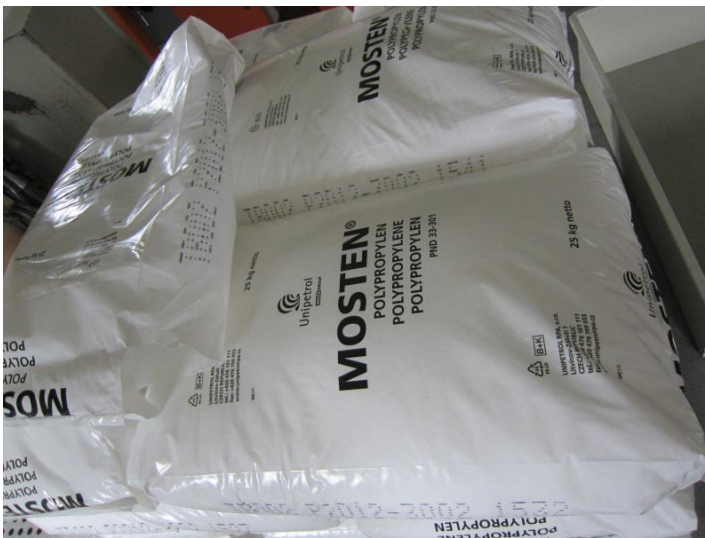
Obr. 7 Granulát polymeru v pytlích a oktábínu [8]
