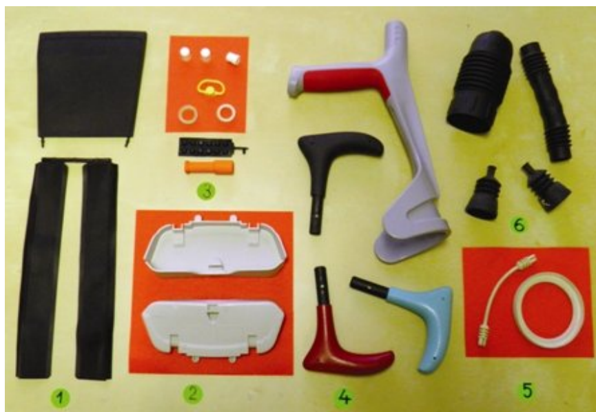
Obr. 4 Výrobky z termoplastických elastomerů [5]
