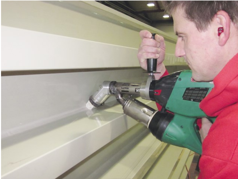
Obr. 6. Svařování za pomoci ručního extrudéru [4]
