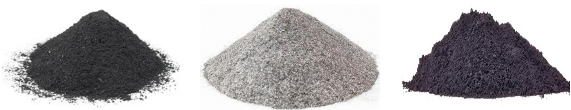
Obr. 25 Částicová plniva (zleva: karbonylové železo, neodymové částice, feritové částice)
