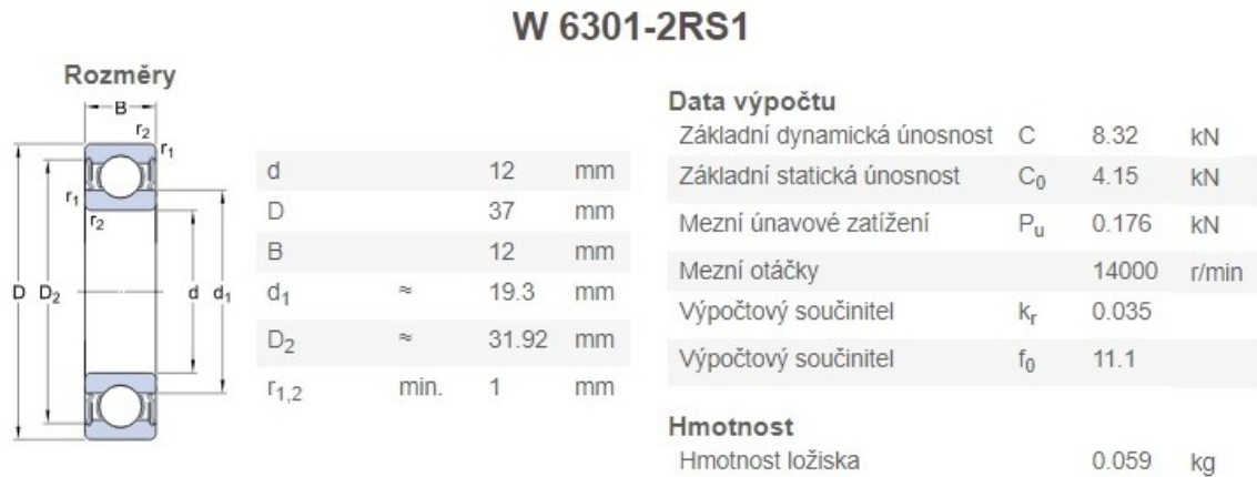
Obr. 54. Specifikace zvoleného ložiska
