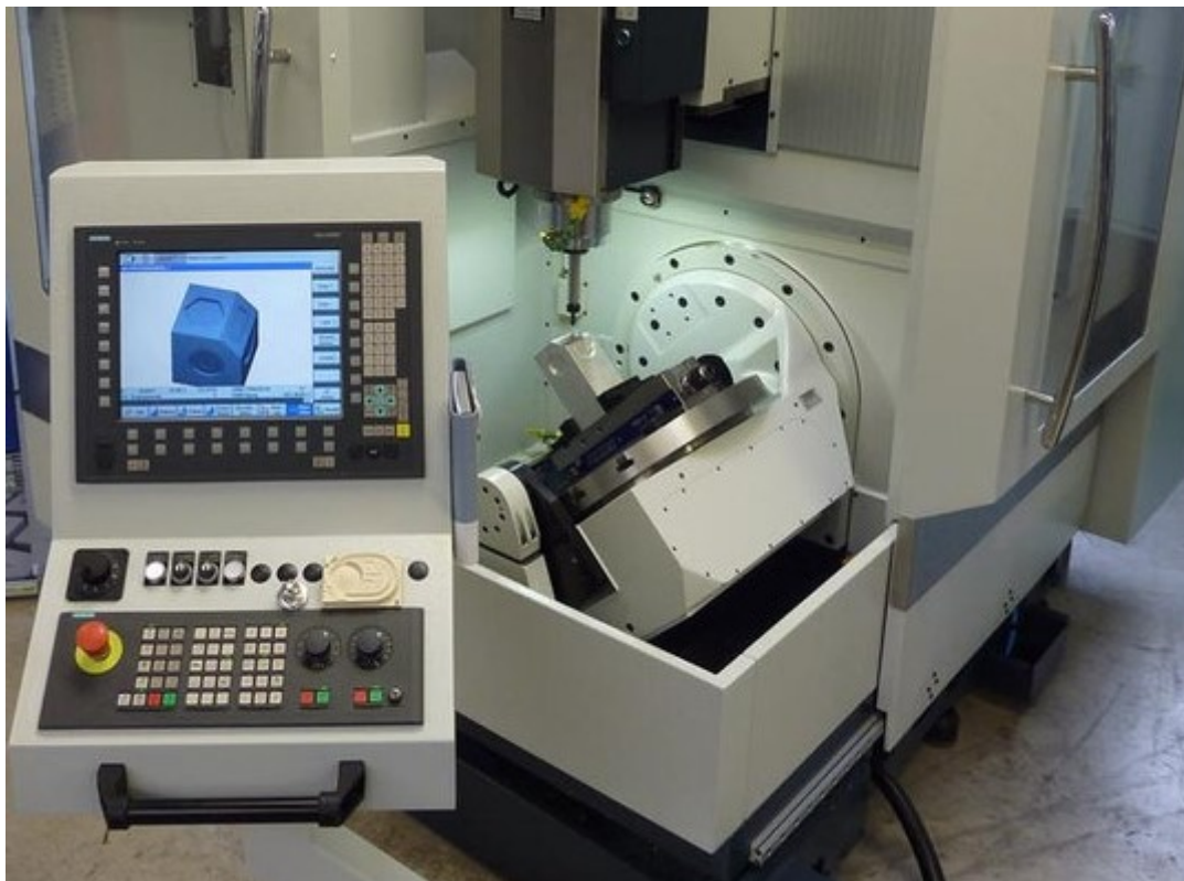
Obr. 11. Obráběcí centrum řízené programem Sinumerik840D [8]
