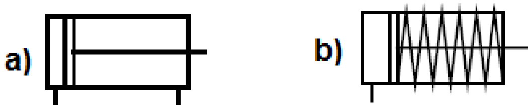
Obr. 27. Dvojčinný (a) a jednočinný (b) pneuválec [17]
