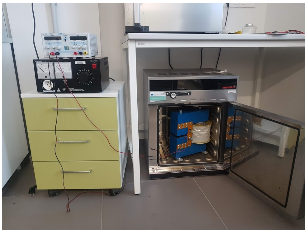
Obr. 18 Sestava zdroje, elektromagnetu a sušárny
