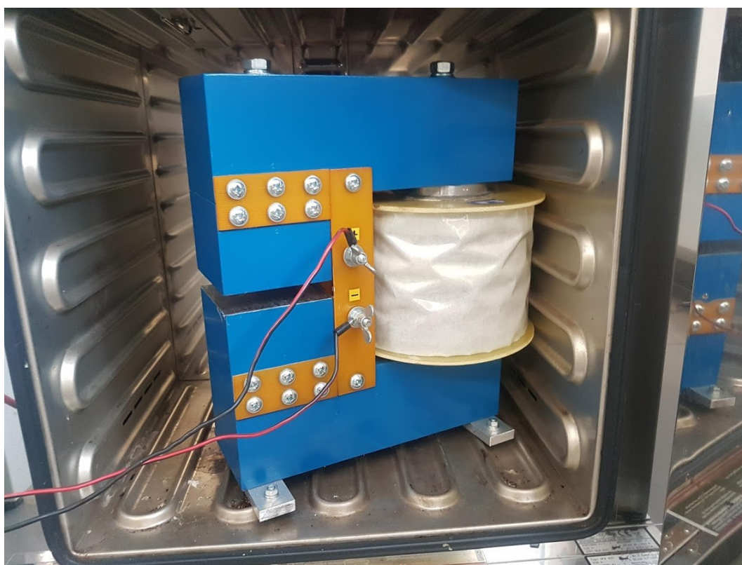
Obr. 19 Elektromagnet pro vytvoření anizotropní struktury MRE
