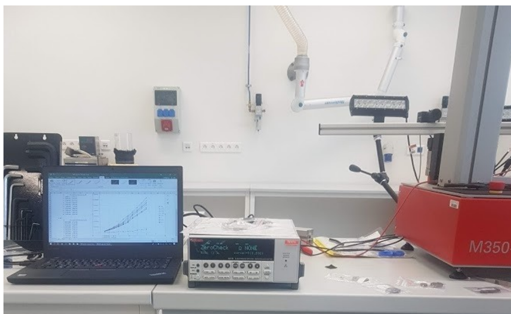
Obr. 20 Programovatelný elektrometr Keithley 6517B v sestavě
