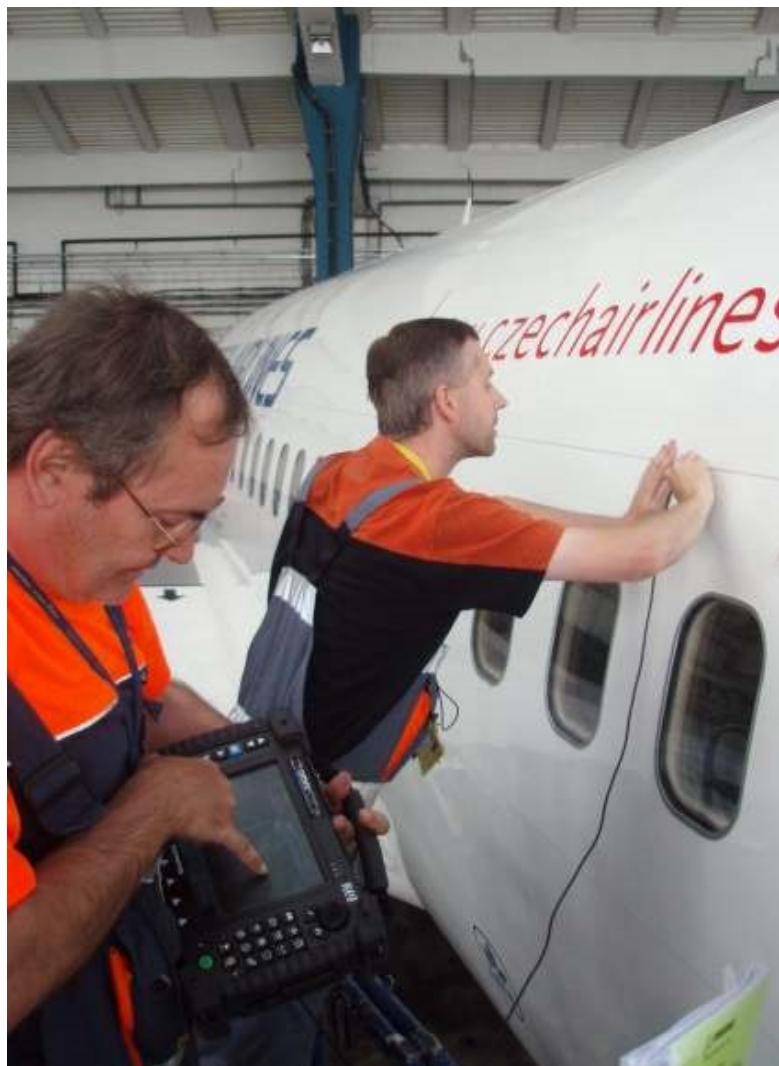
Obrázek 23: Testování trupu letadla pomocí ultrazvukového zařízení (11)
