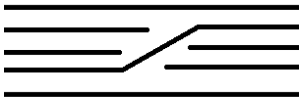
Obr. 34 Schéma vrstvení u vzorku č.6
