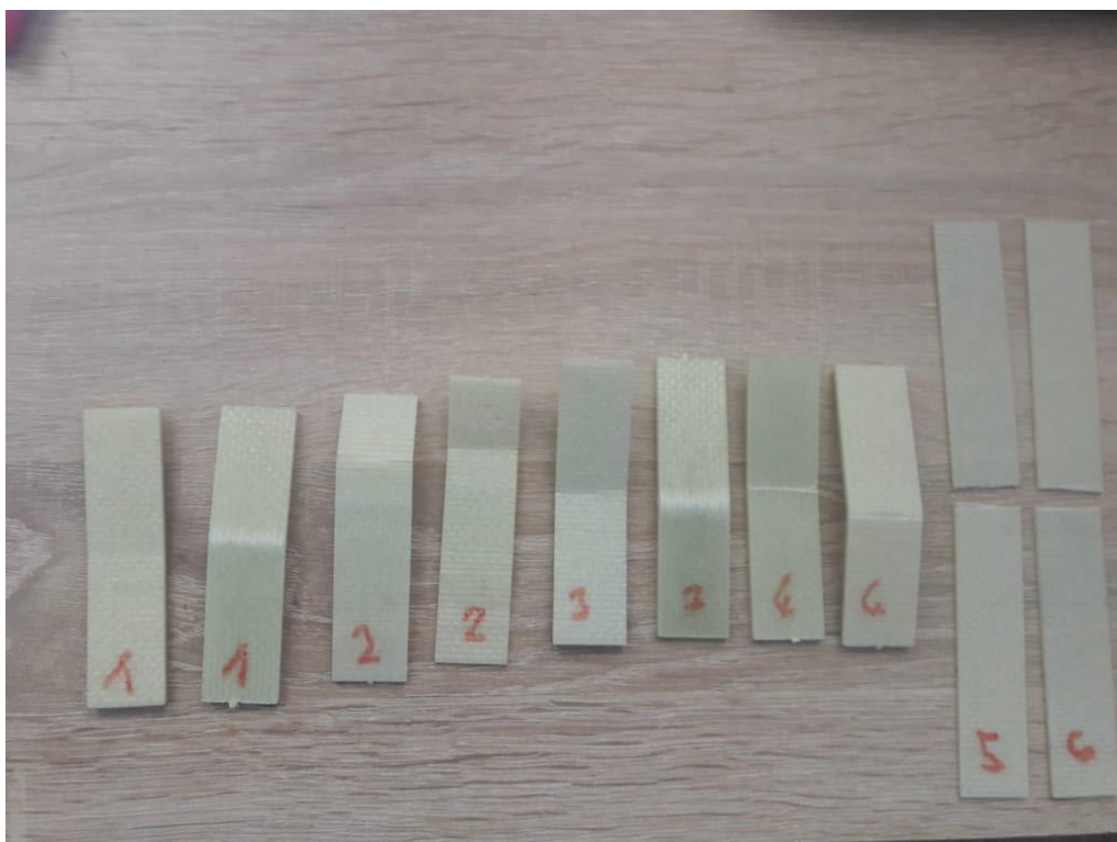
Obr. 52 Jednotlivé vzorky po statických zkouškách
