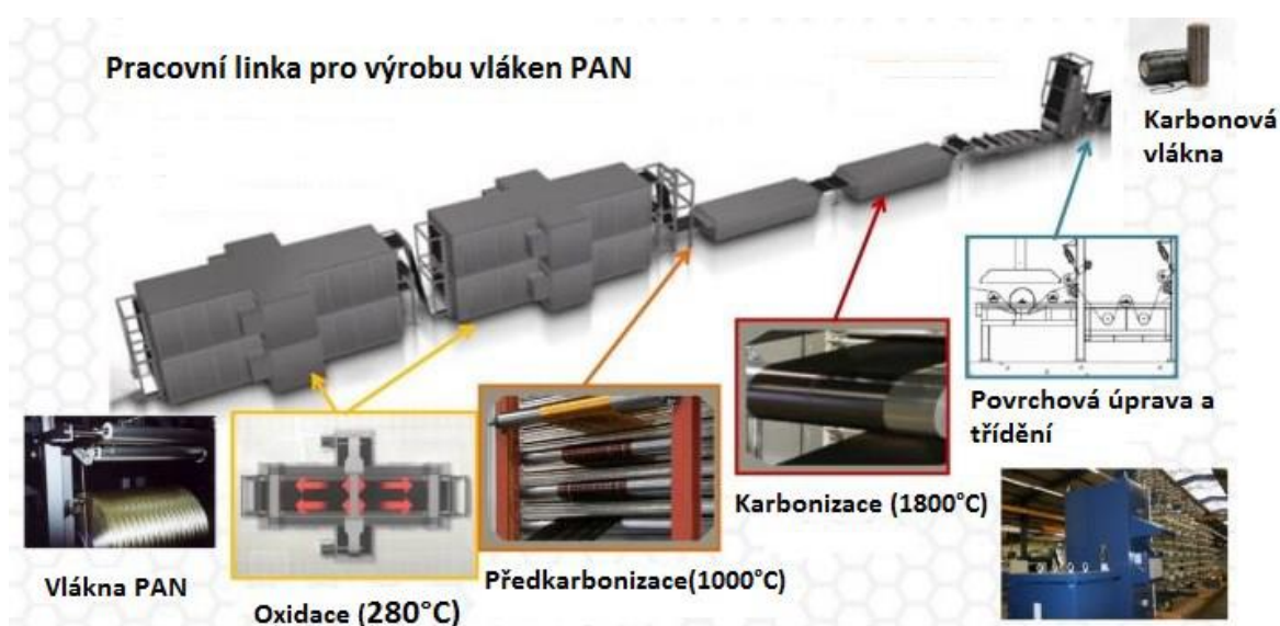
Obr. 11 Pracovní linka pro výrobu vláken PAN [9]
