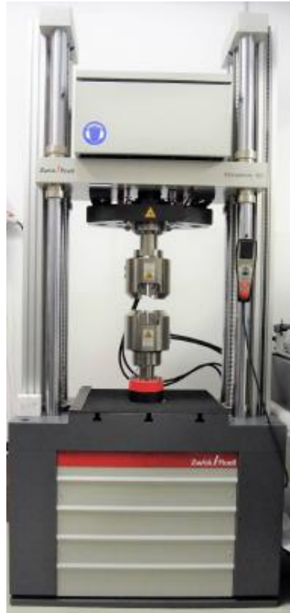
Obr. 45 Zkušební stroj pro statické i dynamické zatěžování Vibrophore 1000
