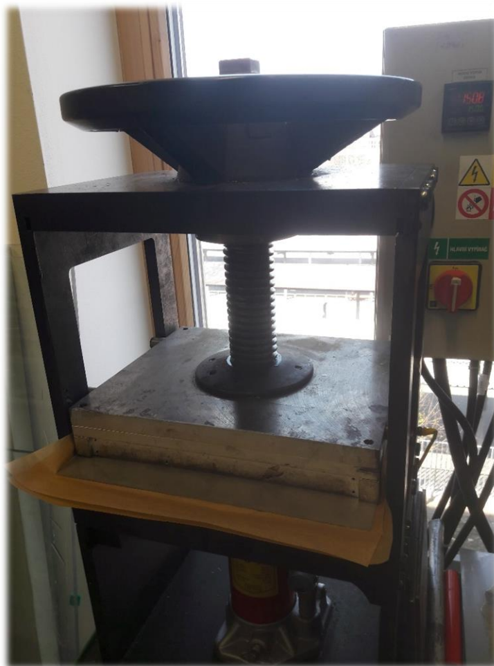
Obr. 28 Příklad lisování mezi vyhřívanými deskami
