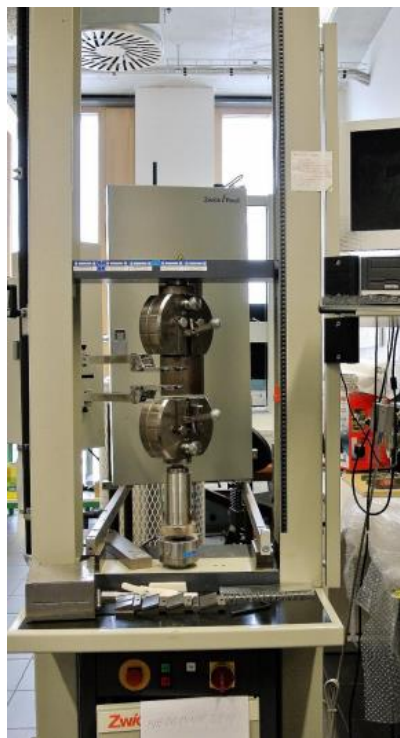
Obr. 36 Zkušební přístroj ZWICK 1456
