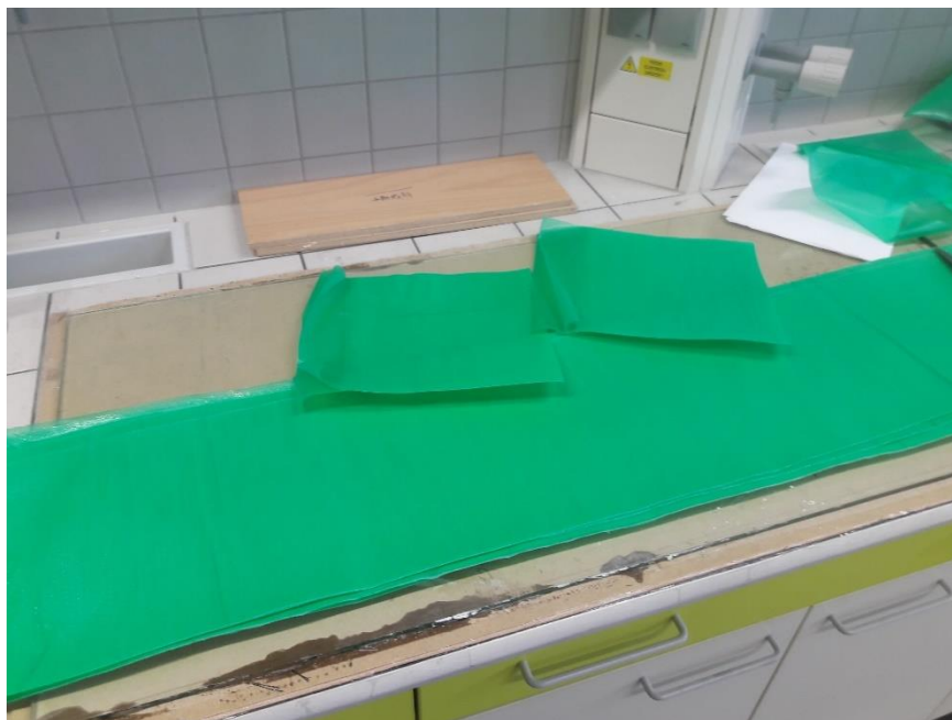
Obr. 26 Ukázka nastříhaných pásů a jednotlivých odstřížků před lisováním
