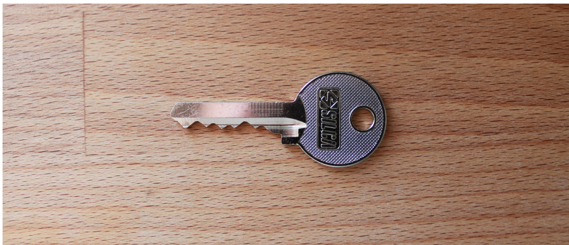
Obr. 26. Vyfrézovaný duplikát klíče.
