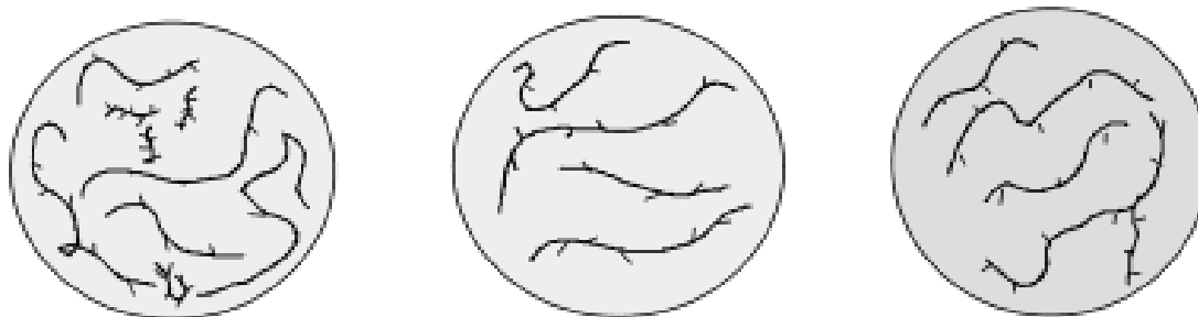
Obrázek 15 Porovnání struktury tří různých PE kopolymerů, připravených různými polymerizacemi (zle-va konvenční LLDPE, homogenní kopolymer metalocenová katalýza, PE s dlouhými větve-mi CGC katalýza) [29].
