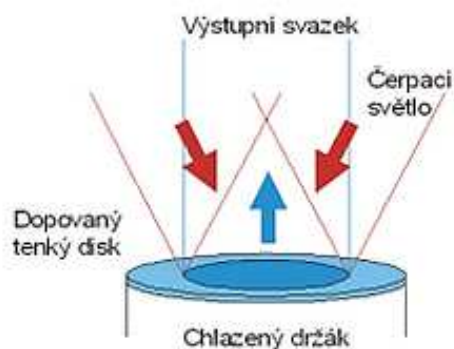
Obr. 2.3: Schéma aktivního prostředí diskového laseru [32]
