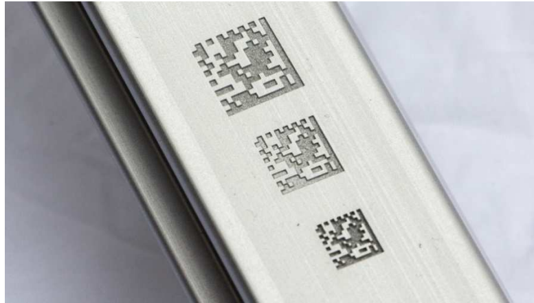
Obr. 3.7: Ukázka gravírování laserem do hliníku [27]
