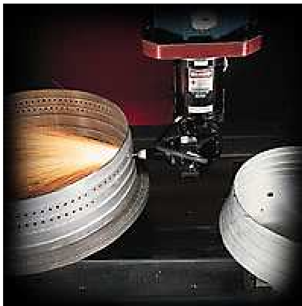
Obr. 3.5: Ukázka vrtání laserem [24]
