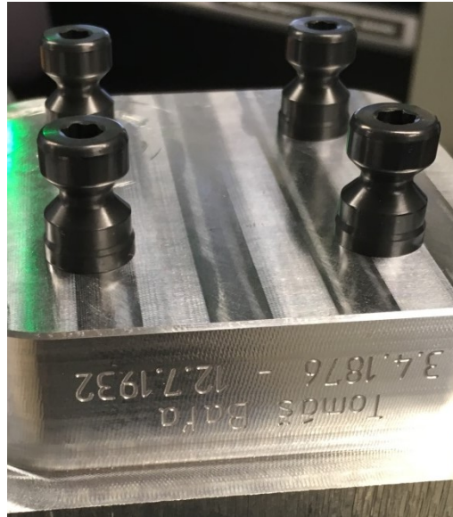
Obr. 19. Závité díry s nasazenými šrouby pro uchycení ve svěráku
