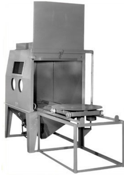
Obr. 35 Tryskací zařízení na plast [22]
