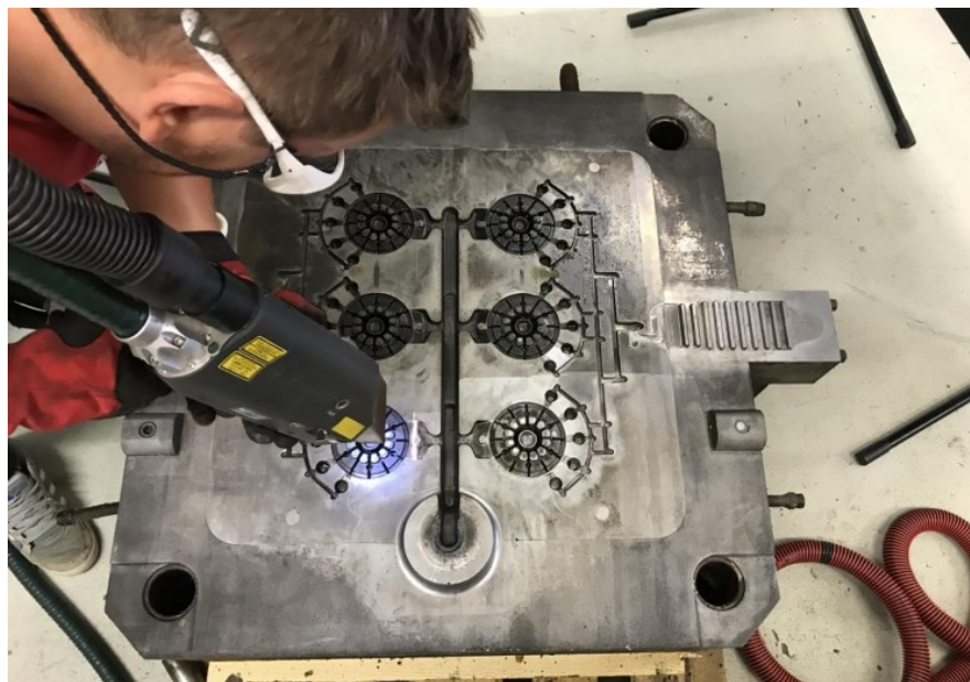
Obr. 6.3 Čištění dutiny formy pomocí laseru [40]
