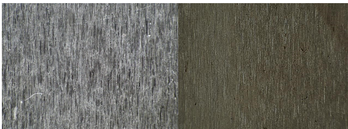
Obr. 10.25 Fotografie povrchu destičky 5 - vlevo před lisováním, vpravo po 200 lisovacích cyklech
