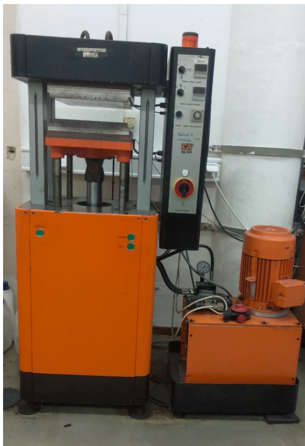
Obr. 9.3 Použitý hydraulický vulkanizační lis IGTT
