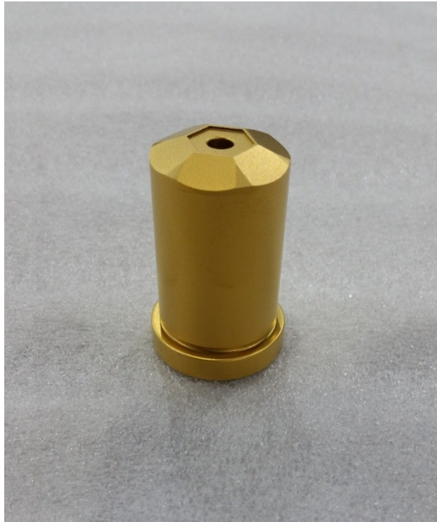
Obr. 5.4 Ukázka povlakované součásti metodou CVD [41]
