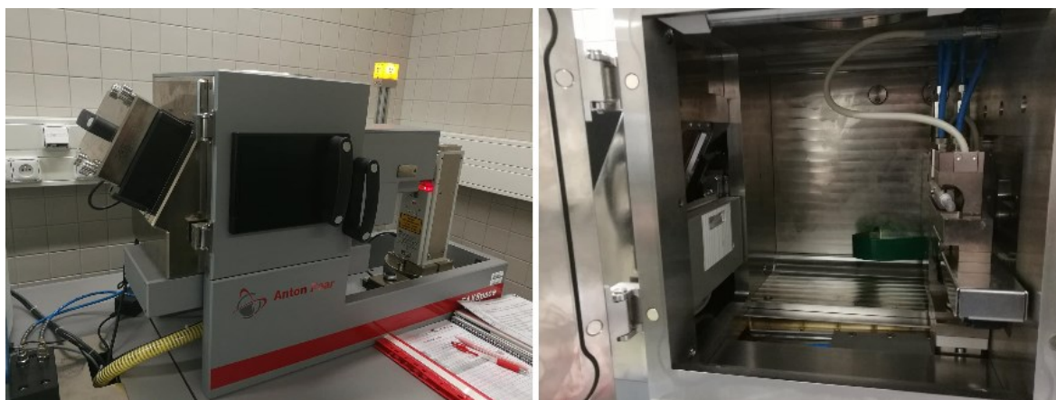
Obrázek 10: Přístroj SAXS Anton Paar SAXSpace a vnitřní komora se vzorkem
