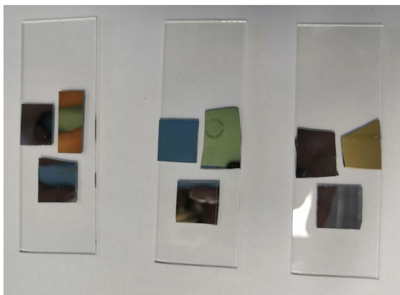
Obrázek 18 Křemíkové wafery s deponovanou vrstvou PLA metodou PECVD.
