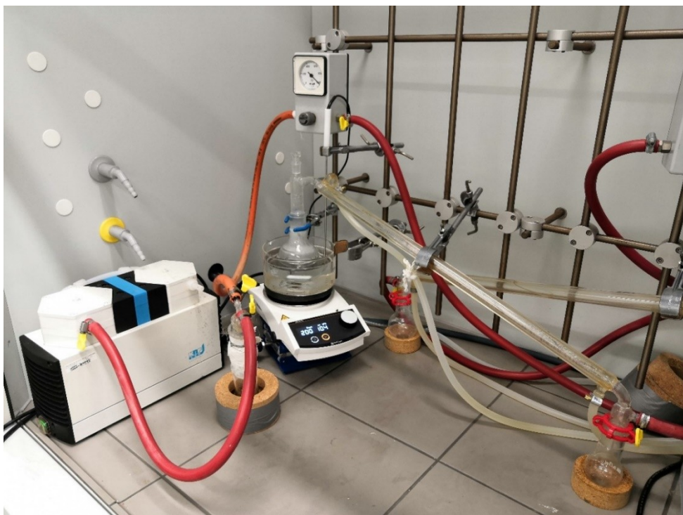
Obrázek 14 Aparatura pro syntézu PLA.
