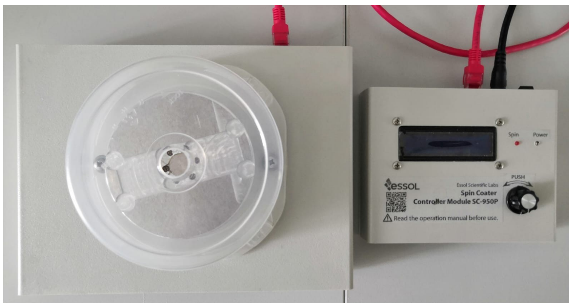
Obrázek 24 Spincoater (Controller Module SC-950P).
