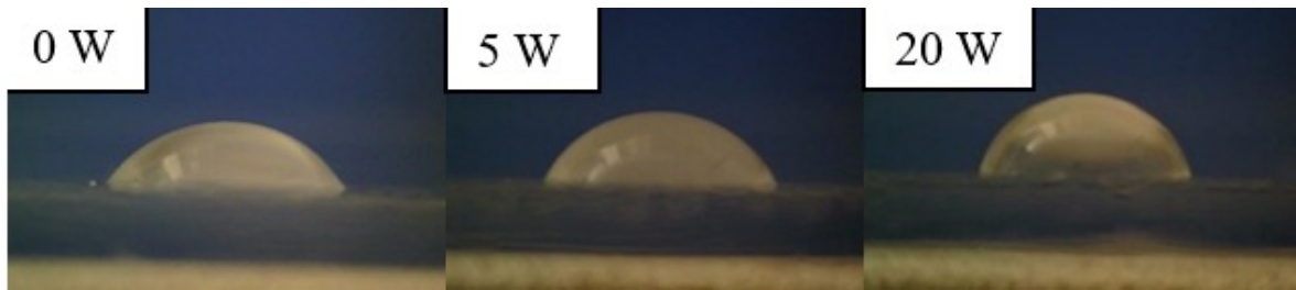
Obrázek 27 Přisedlá kapka vody na deponované vrstvě PLA (PECVD) pro výkon 0; 5 a 20 W.
