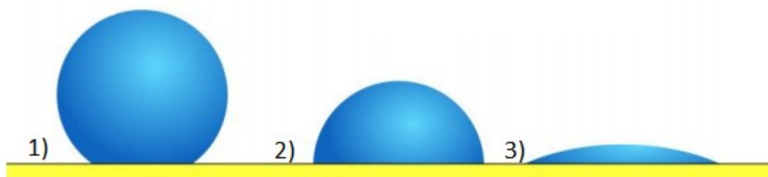
Obrázek 13 - 1) \theta > 90^\circ \rightarrow nedochází ke smáčení, 2) \theta < 90^\circ \rightarrow dochází ke smáčení, 3) \theta = 0^\circ \rightarrow dochází k dokonalému smáčení [67].
