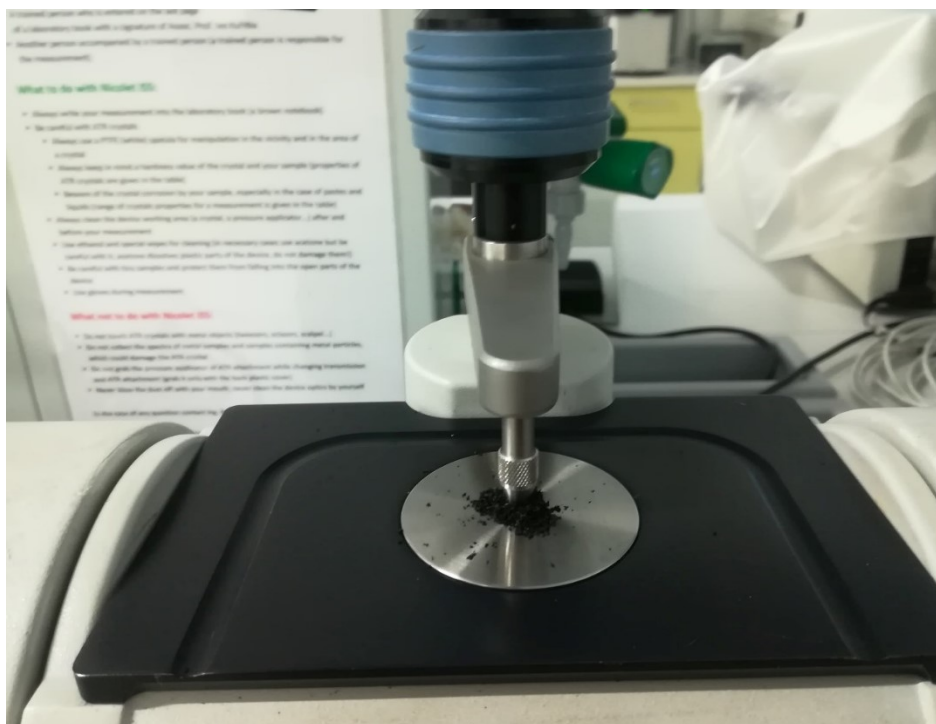
Obr.17 Spektrometr Thermo Scientific Nicolet iS5
