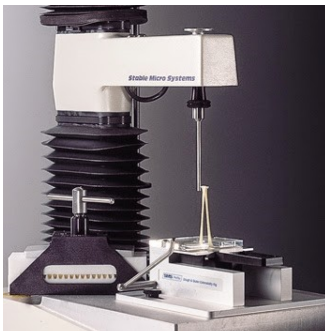
Obrázek 9: Kiefferovo zařízení pro stanovení tažnosti těsta a lepku [57]
