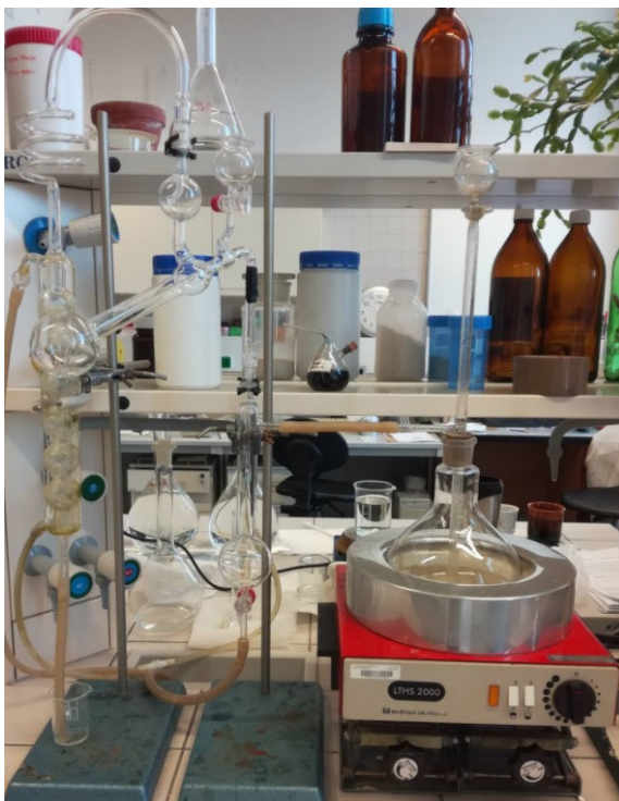
Obr. 11: Parnas-Wagnerova destilační aparatura
