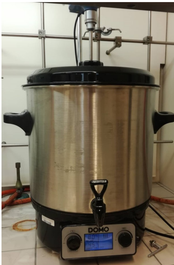
Obr. 6: Zavařovací hrnec Domo s míchacím zařízením využitý pro rozklad vlny
