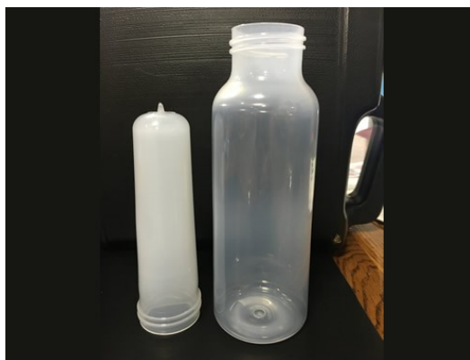
Obr. 105 Předlisk a láhev vyfuknutí [69]
