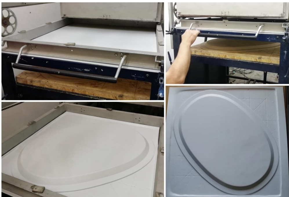
Obr. 80 Proces vákuovania HPS dosky
