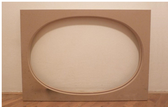
Obr. 85 Forma na vyfúknutie difúzoru
