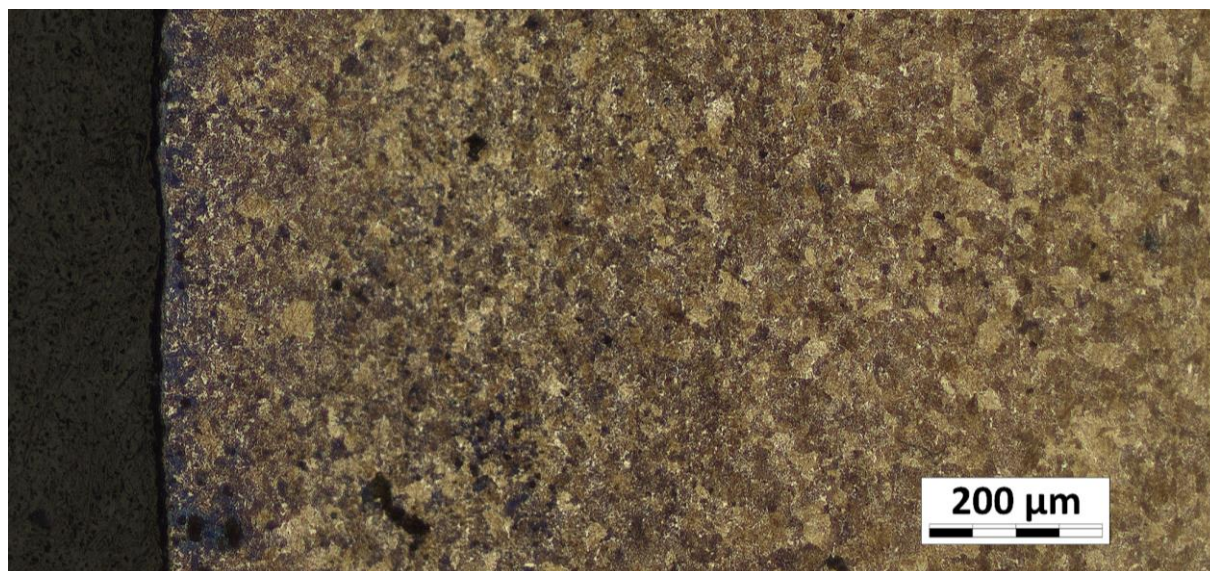
Obr. 21 Struktura oceli 1.7102 v místě řezu po dělení vodním paprskem
