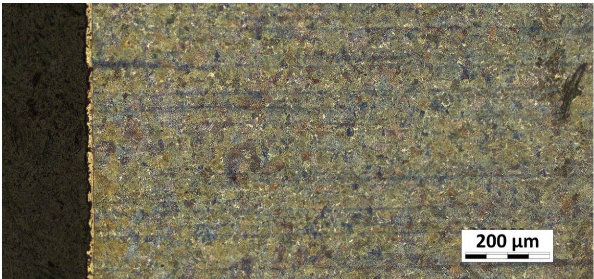
Obr. 19 Struktura oceli 1.7102 v místě řezu po elektroerozivním drátovém řezání
