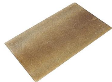
Obr. 28 Drsnost řezné plochy – ocel 1.1702, TL. 15 mm, elektroer. drátové řezání
