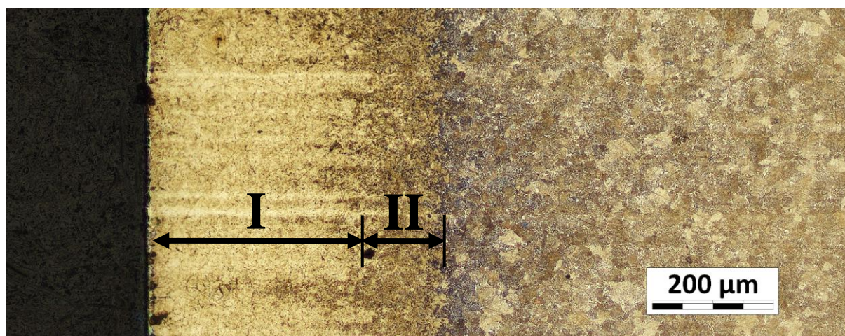
Obr. 17 Struktura oceli 1.7102 v místě řezu po dělení plazmou
