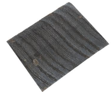
Obr. 27 Drsnost řezné plochy – ocel 1.1702, TL. 15 mm, řez plazmou
