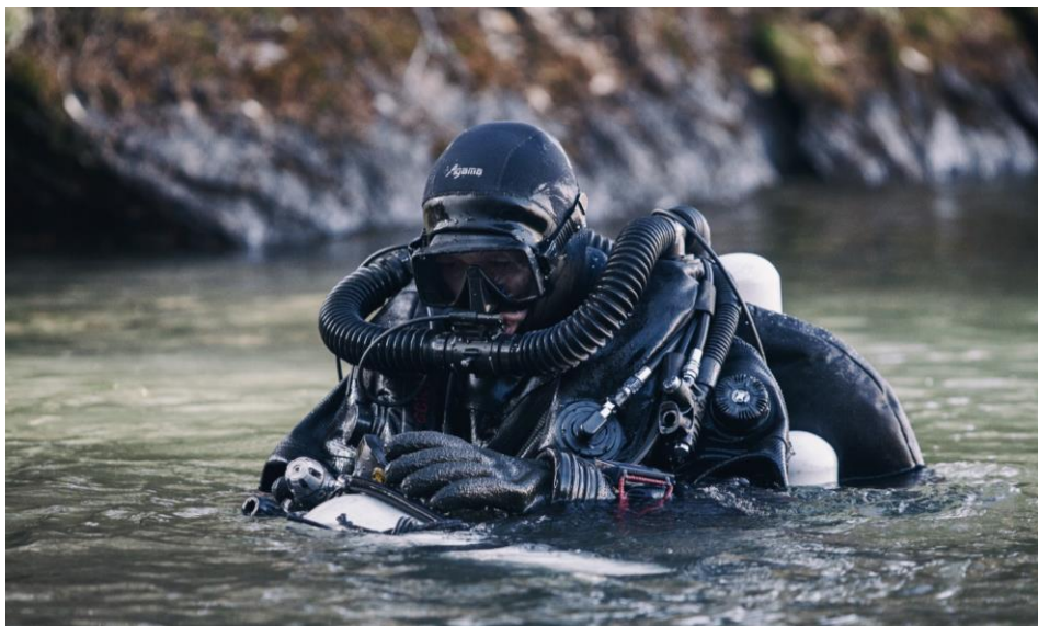
Obrázek 6: Potápěčský dýchací přístroj s uzavřeným okruhem (Interní materiály PČR, 2020)
