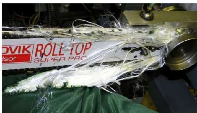
Obrázek 36: Ochranný princip neprořezných kalhot (Marek, Škréta a Skřehot, 2011, s. 38)
