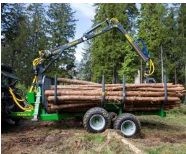
Obrázek 10: Vyvážedka CT 6,3 – 9 4WD s hydraulickou rukou s dosahem 6,3 m, nosností 9 tun ( Vyvazeadreva.cz , ©2009–2020)
