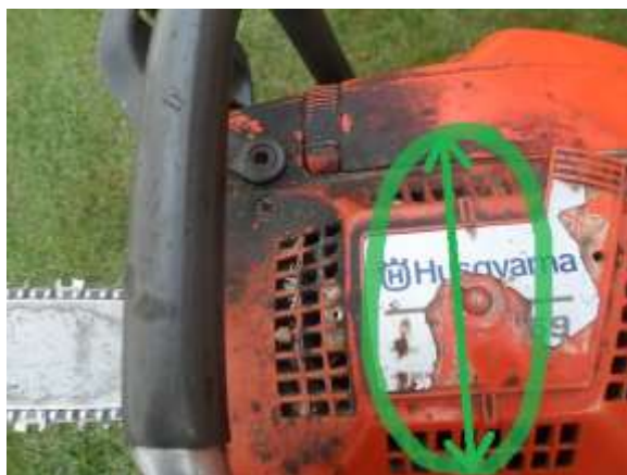
Obrázek 26: Směrové značky na krytu pily pro určení směru kácení, zdroj: Vlastní zpracování
