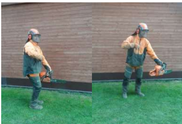
Obrázek 21: Zakázaný způsob startování MP, zdroj: Vlastní zpracování
