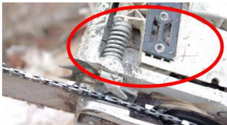
Obrázek 40: Silentbloky u MP (Marek, Škréta a Skřehot, 2011, s. 73)
