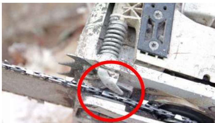
Obrázek 19: Zachycovač řetězu u MP (Marek, Škréta a Skřehot, 2011, s. 69)
