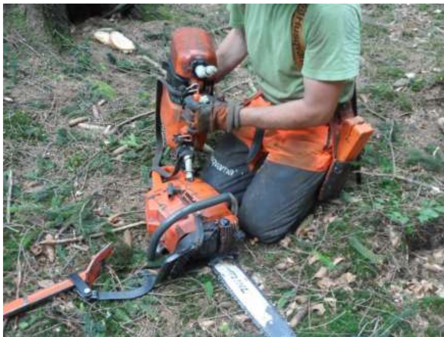
Obrázek 46: Doplnění nádrží MP z kanystru bez využití násadce autostop, zdroj: Vlastní zpracování
