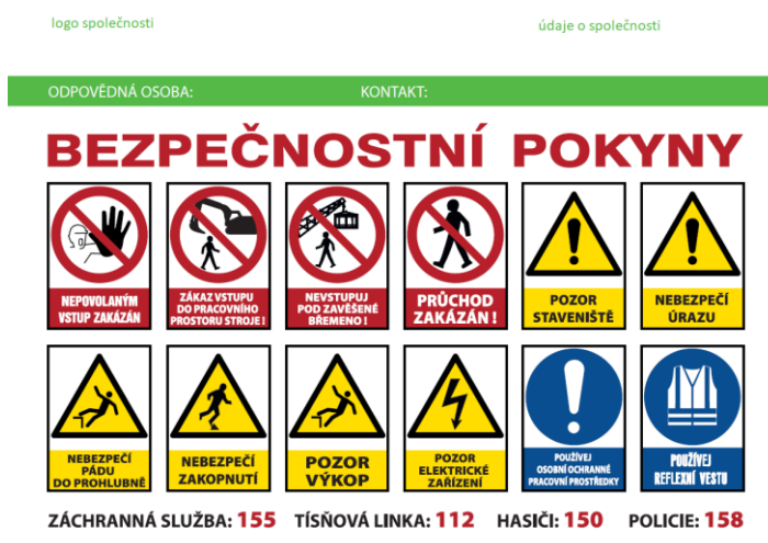
Obr. 1. Příklad bezpečnostní tabule na staveništi [18]
