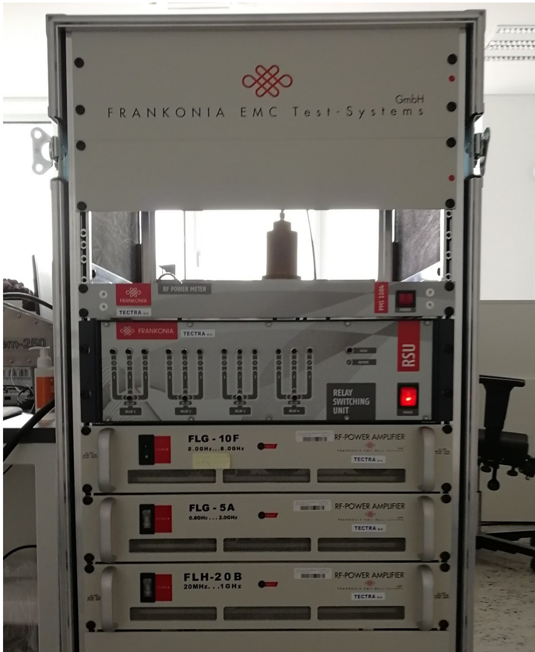
Obrázek 32 – Zesilovače a reléový spínací panel od firmy Frankonia.
