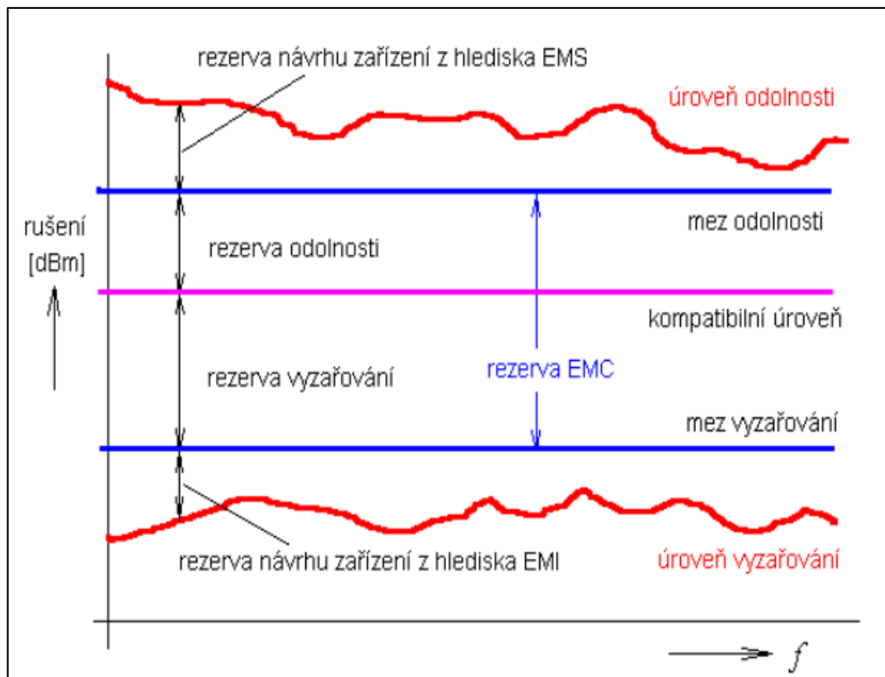
Obrázek 1 – Definice úrovní a mezí vyzařování a odolnosti. [1]
