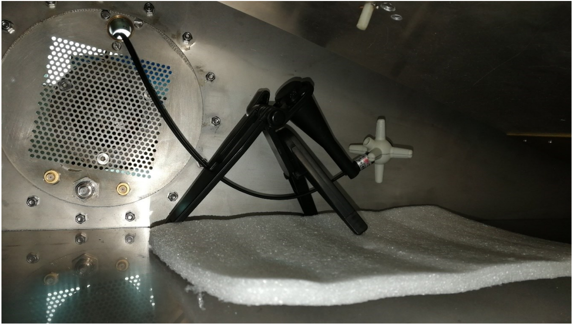
Obrázek 36 – Ukázka umístění sondy v GTEM cele.
