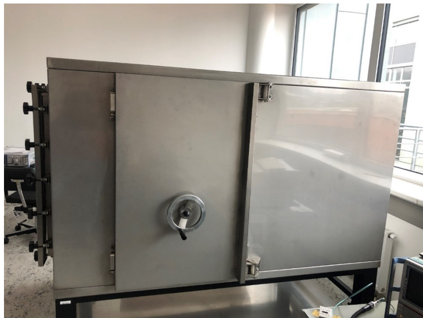
Obr. 19 – Testovací komora EMC. [zdroj vlastní]
