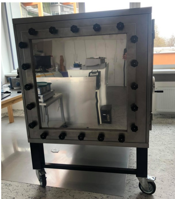
Obr. 17 – Testovací komora EMC. [zdroj vlastní]
