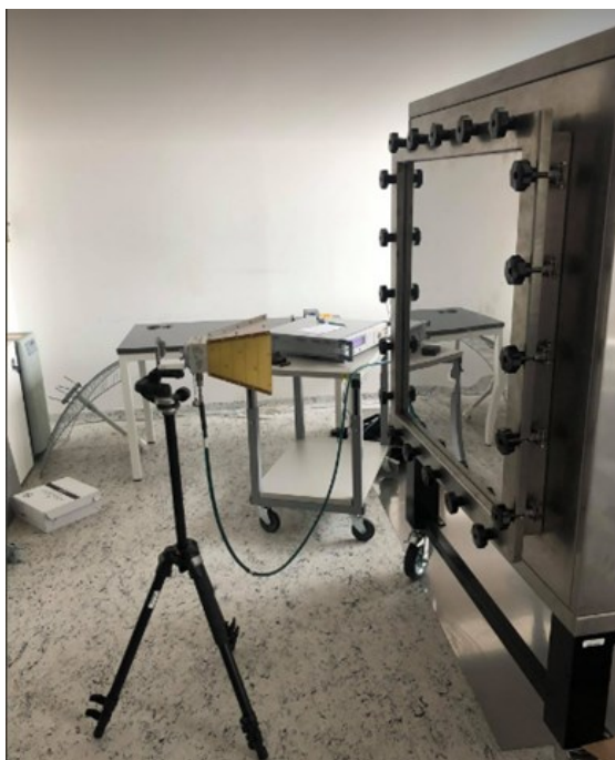
Obr. 33 – Měření bodu E ve vzdálenosti 50 cm [zdroj vlastní]
