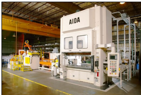
Obrázek 3: Příklad souboru strojních zařízení – lisovací linka [39]
