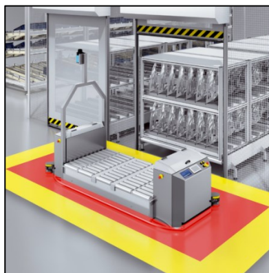
Obrázek 19: Vizualizace bezpečnostních zón laserového skeneru Sick [51]
