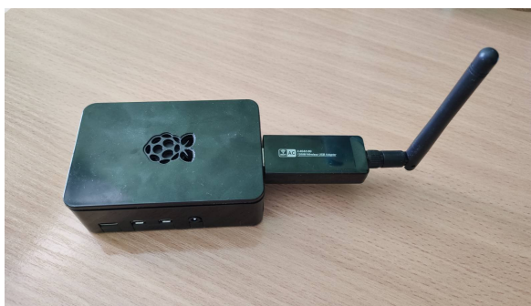
Obrázek 4.2 Raspberry Pi s pripojeným adaptérom RTL8812AU
