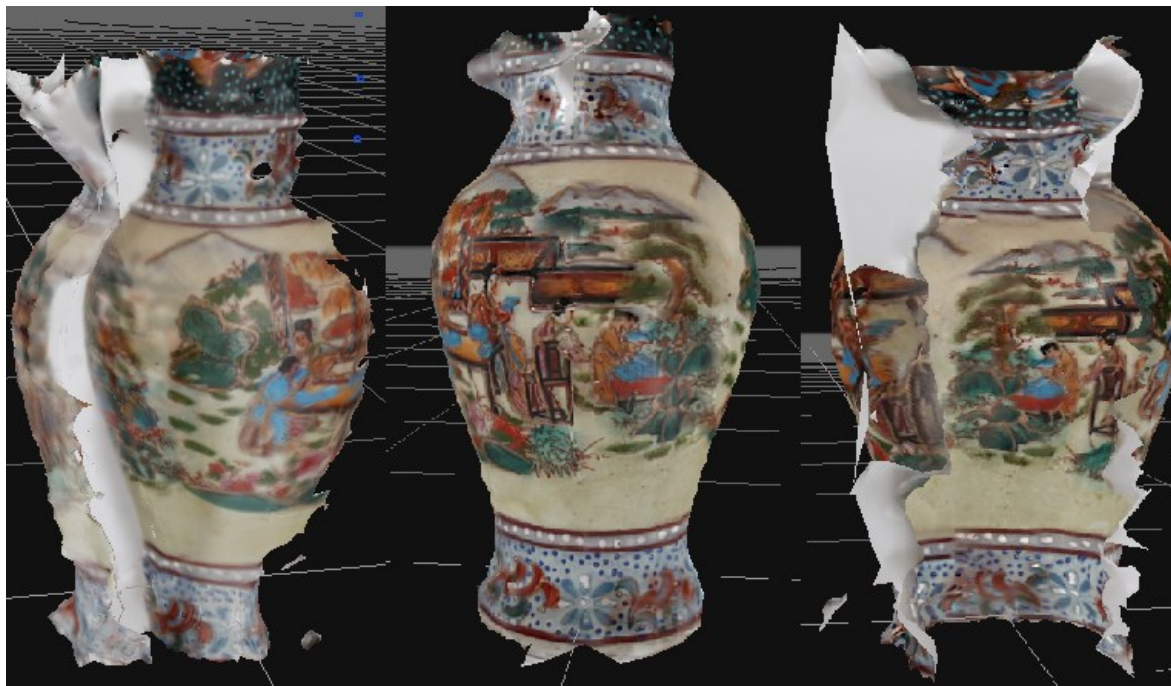
Obrázek 44: Rekonstrukce pomocí obrazů s různým rozlišením 3DF Zephyr Vlevo 2592 x 1728, uprostřed 1296 x 864, vpravo 648 x 432
