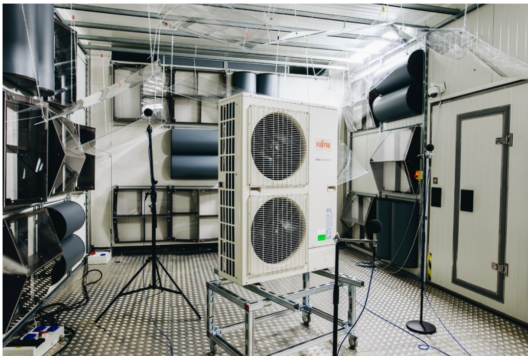
Obrázok 14. Univerzálna kompenzovaná kalorimetrická komora - meranie LW podľa ČSN EN ISO 3741 a ČSN EN ISO 3743 a ČSN EN ISO 354
