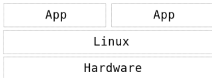
Obrázek 3. Schéma principu kontejnerové virtualizace [7]
