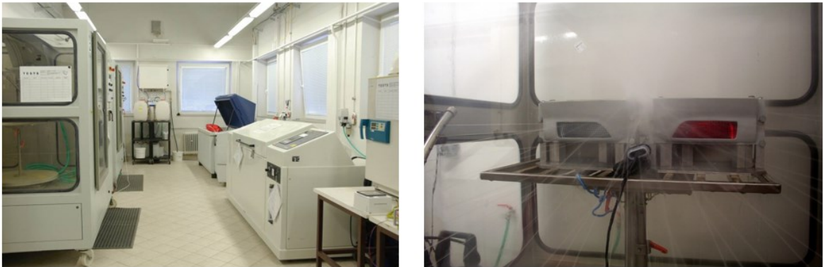
Obrázek 12 – Komory k testování odolnosti vody a koroze. Zdroj: (Zdroj firma).
