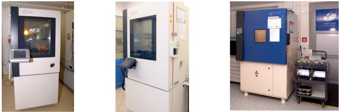
Obrázek 10 – Klimatická komora pro tepelné a klimatické zkoušky. Zdroj: (Zdroj firma).
