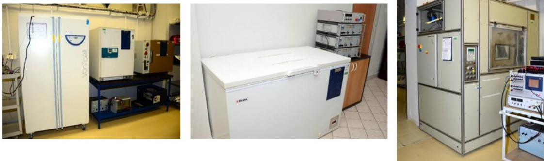
Obrázek 11 – Testovací komory pro vysoké a nižší teploty a prachu. Zdroj: (Zdroj firma).
