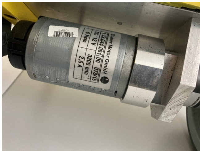
Obrázek 20 Instalovaný DC motor s převodovkou a enkodérem
