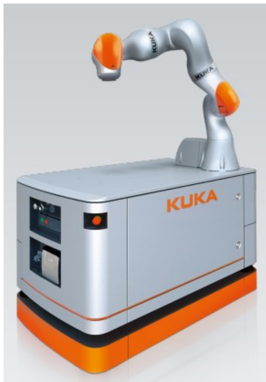
Obrázek 19 Kuka KMR iiwa [34]
