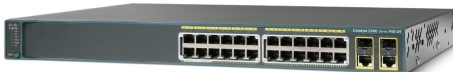
Obr. 17 Původní koncový přepínač Cisco v technologické síti [41]
