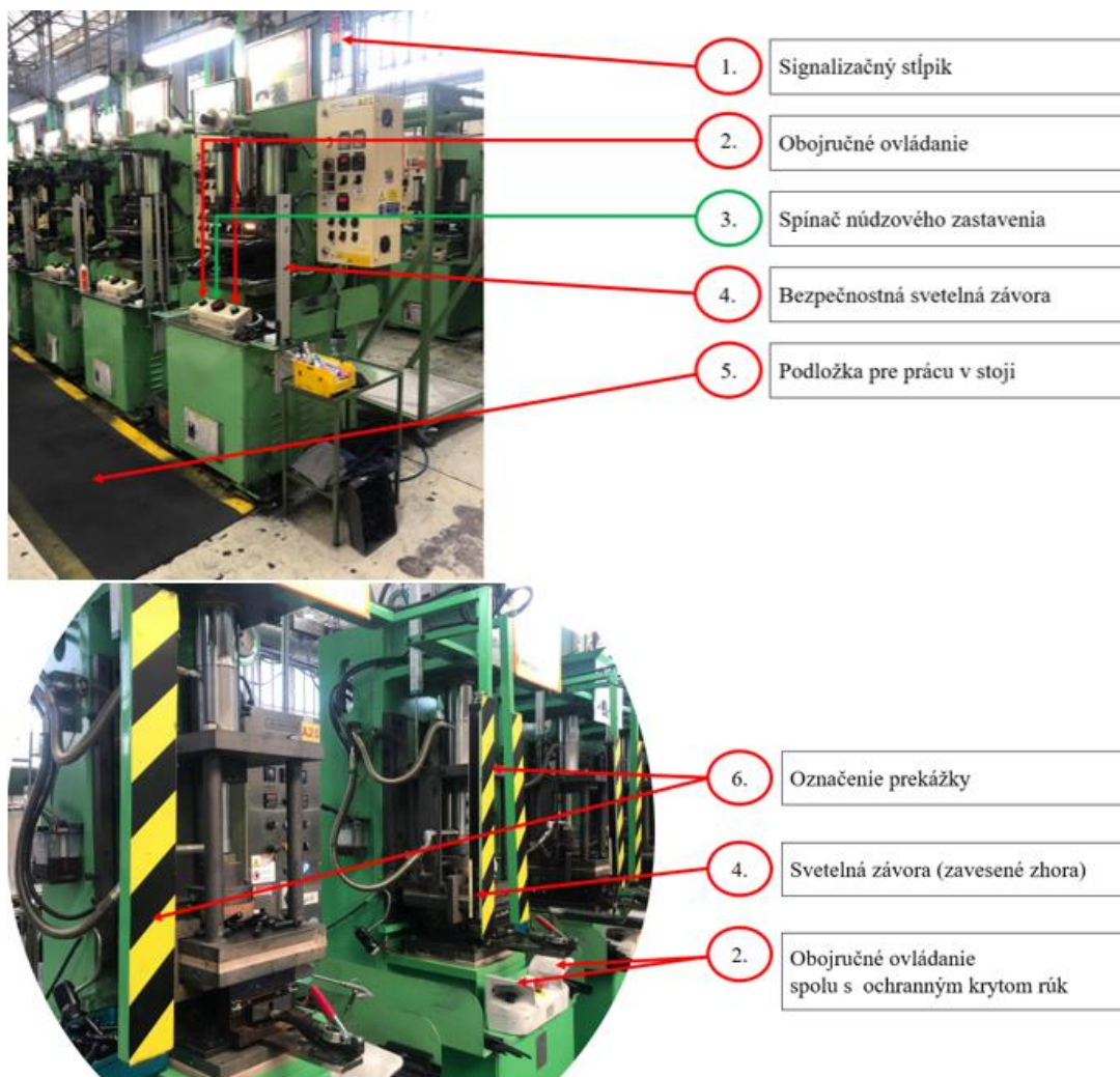
Obrázok 12 Bezpečnostné prvky pracoviska – lis (vlastné)
