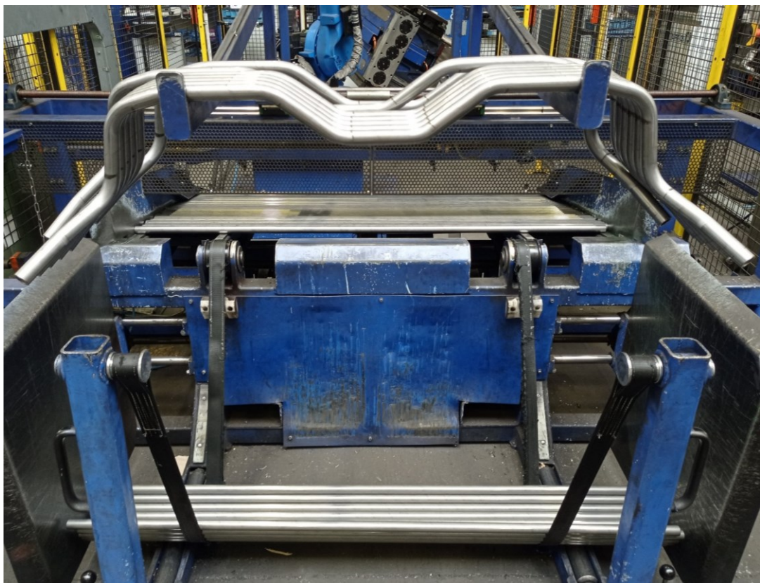
Obrázek 13 Tyče před (dole) a po (nahore) ohýbání strojem (vlastní zpracování)
