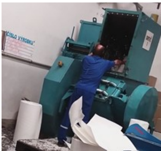
Obrázok 51 Ohrozovanie zdravia vtláčaním rúk do komory (vlastné spracovanie)
