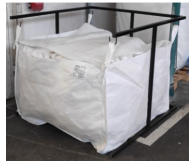
Obrázok 61 Závesná konštrukcia do výroby (vlastné spracovanie)
