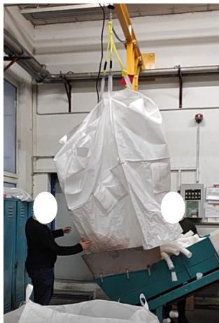
Obrázok 63 Test manipulácie a vysypávania (vlastné spracovanie)
