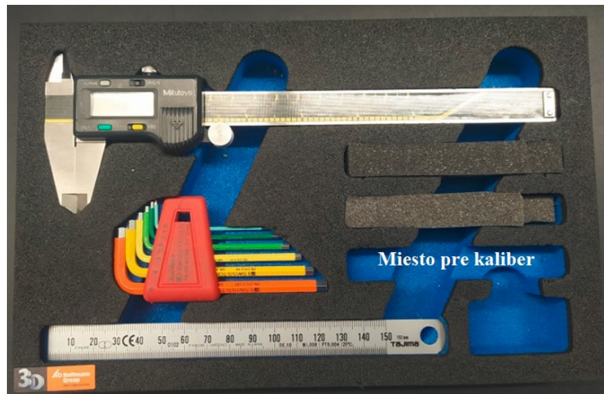
Obrázok 27 Shadowboard pre kontrolu izolačných trubičiek (interný materiál spoločnosti)
