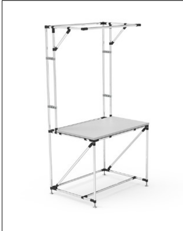
Obrázok 19 Návrh pracovného stolu operácie č.5 (doska: 75 cm x 60 cm; výška stolu: 82 cm)
