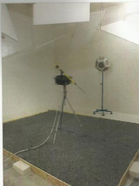
Zkušební vzorek v dozvukové místnosti
